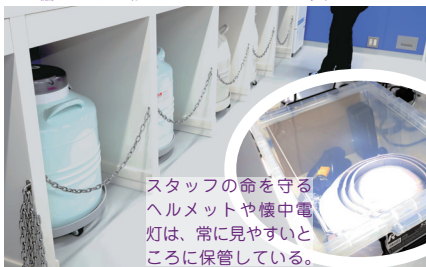
凍結タンクは、作業台下の棚へ個別に設置し、チェーンで棚から出て動きまわらないように工夫している。
